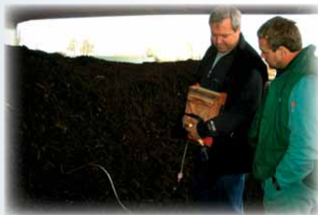
↑ Εικόνα 36: Η τακτική ποσοτική μέτρηση των αερίων [ O_2 , CO_2 , CH_4 ], οι συγκεντρώσεις των οποίων μεταβάλλονται κατά τη διάρκεια της κομποστοποίησης, με ειδικό προς τούτο φορητό πρότυπο όργανο μέτρησης, είναι πρακτικά μία απαραίτητη εργασία, προκειμένου να παρακολουθείται επακριβώς η ακριβής πορεία της κομποστοποίησης.
