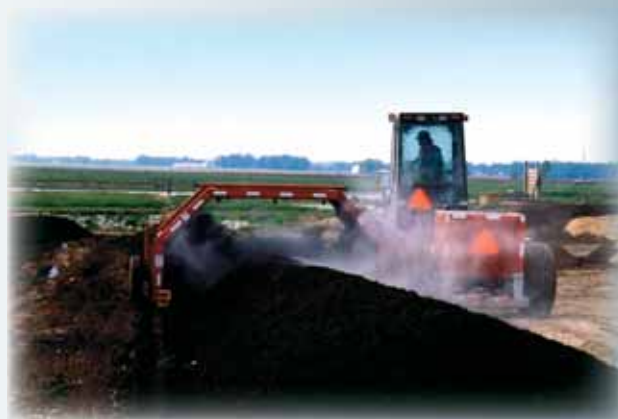
↑ Εικόνα 26: Άλλο παράδειγμα αναστροφής σειραδίων κομποστοποίησης ιλύος αστικών λυμάτων με κλασσικό αναστροφέα. Αξίζει να σημειωθεί ότι, κακώς, δεν υπάρχουν παραπετάσματα ασφαλείας εμπρός και πίσω από τον αναστροφέα, για λόγους ενδεχόμενης μερικής προστασίας των ανθρώπων, που, επίσης κακώς, ίστανται εκεί, από τυχόν εκσφεδονιζόμενους λίθους.
