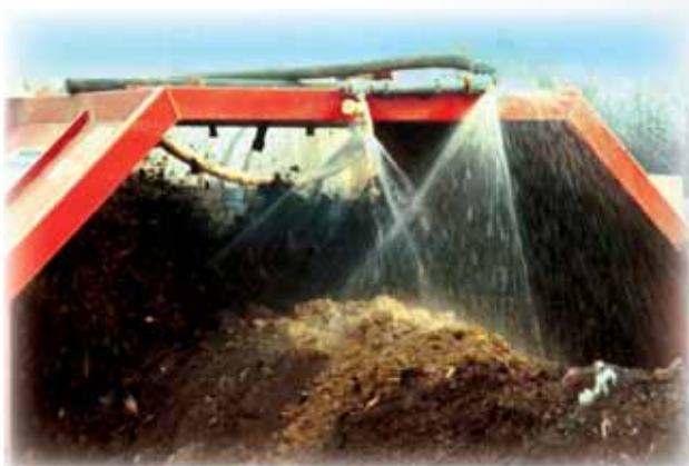
↑ Εικόνα 25: Λεπτομέρεια μηχανισμού διαβροχής των σειραδίων κατά τη διάρκεια της αναστροφής.
