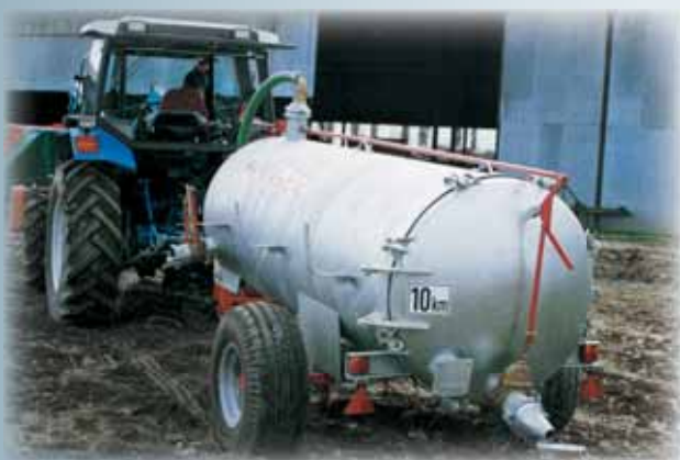
Εικόνα 41: Παράδειγμα ελκυσμένου βυτίου διασποράς υγρών λυμάτων, που παίρνει κίνηση από τυπικό γεωργικό ελκυστήρα, με το οποίο μπορεί να γίνεται η διαβροχή των σειραδίων για τον εμπλουτισμό αυτών με υγρασία και με θρεπτικά [Κτήμα ΣΓΕ Αλιάρτου του ΕΘΙΑΓΕ, Αλιάρτος Βοιωτίας].
