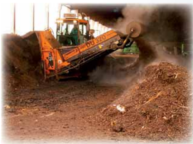
← Εικόνα 27: Παράδειγμα αναστροφέα σειραδίων ιλύος αστικών λυμάτων διαφορετικής τεχνολογίας, σε ανοικτά συστήματα κομποστοποίησης, δια του οποίου τα αναστρεφόμενα υλικά μεταφέρονται σε διπλανή θέση. Ο τύπος αυτός του αναστροφέα είναι περισσότερο κατάλληλος για σειράδια τραπεζοειδούς διατομής.
