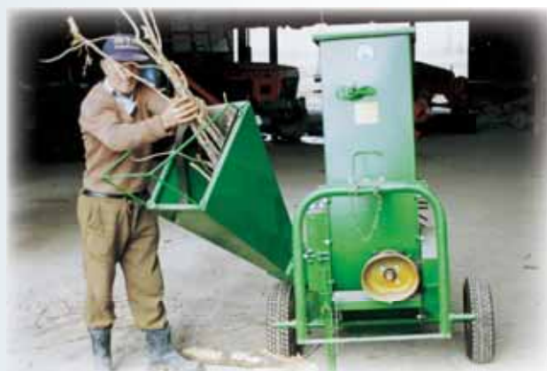
Εικόνα 42: Παράδειγμα κλαδοθρυμματιστή [shredder], μικρών σχετικά διαστάσεων, που παίρνει επίσης κίνηση από τυπικό γεωργικό ελκυστήρα. Ο κατάλληλος κλαδοθρυμματιστής, πιθανώς μεγαλύτερων διαστάσεων από τον προκείμενο είναι απαραίτητος, ιδιαίτερα όταν πρόκειται να χρησιμοποιηθούν λεπτοτεμαχισμένα φυτικά απορρίμματα για το σχηματισμό κομποστοποιούμενου μίγματος με σωστή αναλογία C/N [Κτήμα ΣΓΕ Αλιάρτου του ΕΘΙΑΓΕ, Αλιάρτος Βοιωτίας].
