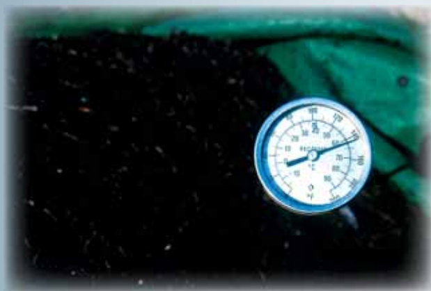
↑ Εικόνα 35: Τακτικές μετρήσεις θερμοκρασίας με ειδικό προς τούτο θερμόμετρο είναι απολύτως απαραίτητες στα κομποστοποιούμενα σειράδια, προκειμένου να ελέγχεται επακριβώς η πορεία της διαδικασίας.
