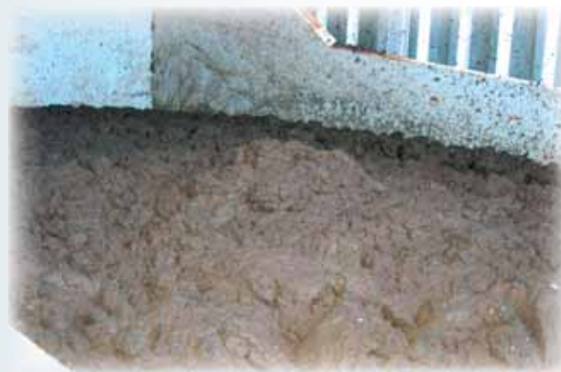
↑ Εικόνα 7: ΚΕΛ Λάρισας. Συγκέντρωση ιλύος, μετά την αφύγρανσή της, σε ειδικά δοχεία. [Φωτ.: Αργ. Παπακωνσταντίνου]
