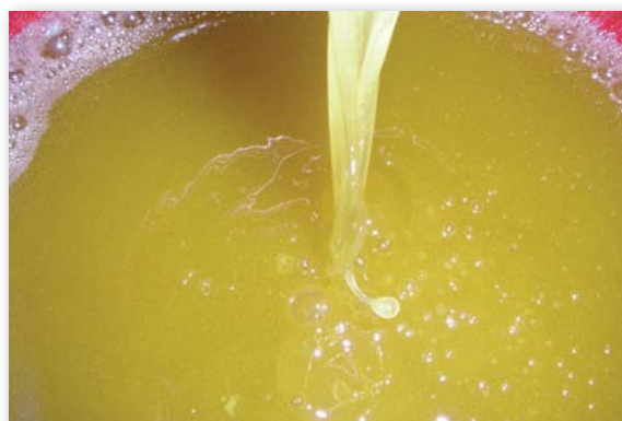
Φωτογραφία 17. Τελικός διαχωρισμός στους κάθετους φυγοκεντρωτές όπου διαχωρίζεται το λάδι από το νερό (τελικός καθαρισμός του ελαιόλαδου).
