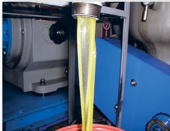
Φωτογραφία 17. Τελικός διαχωρισμός στους κάθετους φυγοκεντρωτές όπου διαχωρίζεται το λάδι από το νερό (τελικός καθαρισμός του ελαιόλαδου).
