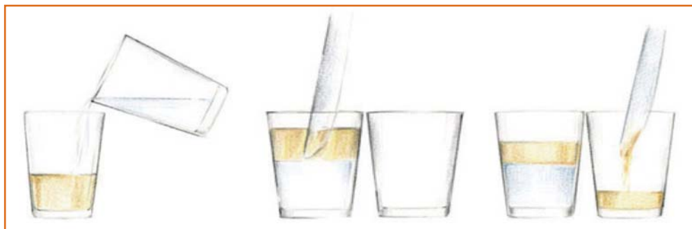
Σχήμα 4. Πείραμα που εξηγεί την αρχή λειτουργία της μεθόδου SINOLEA.
