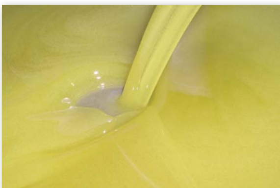
Φωτογραφία 17. Τελικός διαχωρισμός στους κάθετους φυγοκεντρωτές όπου διαχωρίζεται το λάδι από το νερό (τελικός καθαρισμός του ελαιόλαδου).
